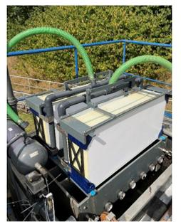
Abbildung 2: Membranblöcke mit zwei verschiedenen Membranmaterialien (Quelle: WTA UNISOL)
