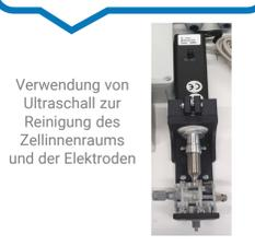
Verwendung von Ultraschall zur Reinigung des Zellinnenraums und der Elektroden
