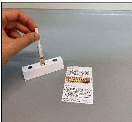
**Schritt 3:** Nimm das Teststäbchen heraus und vergleiche den Teststreifen mit der pH-Wert-Tabelle und notiere den Wert mit der größten Übereinstimmung.
